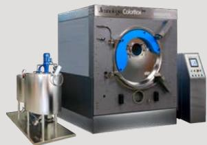
**ColorBox 420** es una máquina de tintura de alta velocidad que ahorra agua y energía y optimiza cualquier tipo de acabado en prenda.
